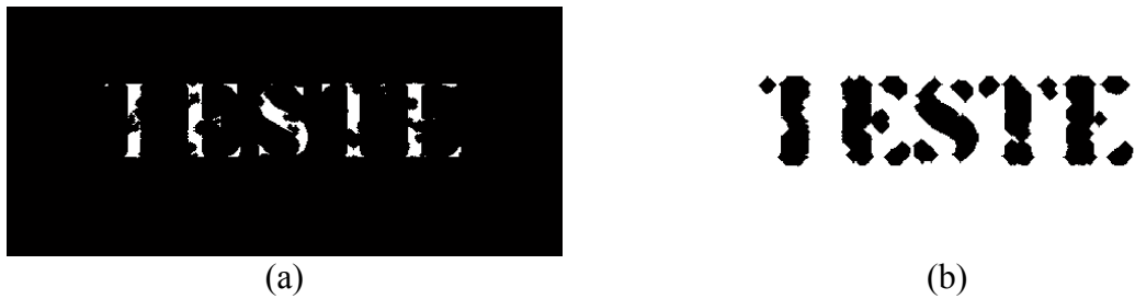
Figura 28 – (a) Erosão e (b) dilatação
