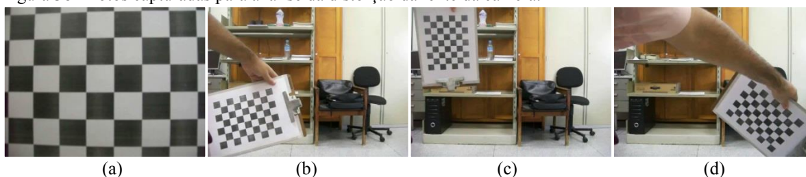
Figura 38 - Fotos capturadas para análise da distorção da lente da câmera.
