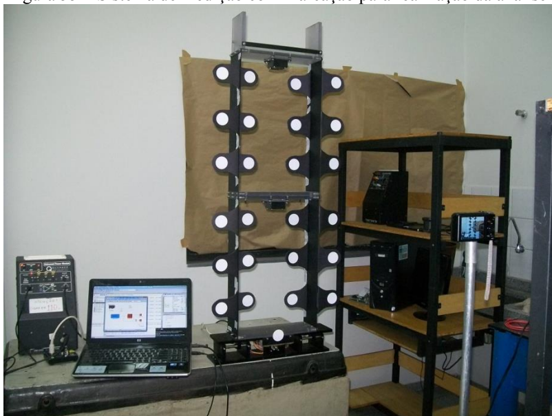
Figura 55 – Sistema de medição com marcação para realização da análise modal
