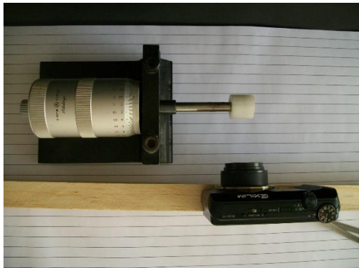
Figura 49 – Sistema de medição com micrômetro para testes estáticos
