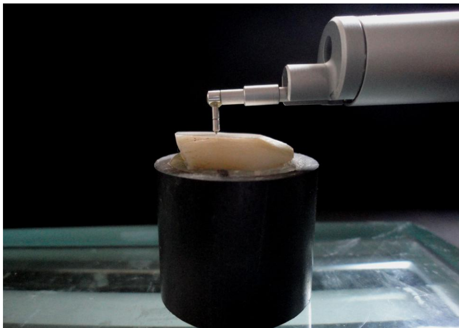
Figura 6 – Realização da leitura inicial no rugosímetro SJ-401 (Mitutoyo, Kanagawa, Japão).
