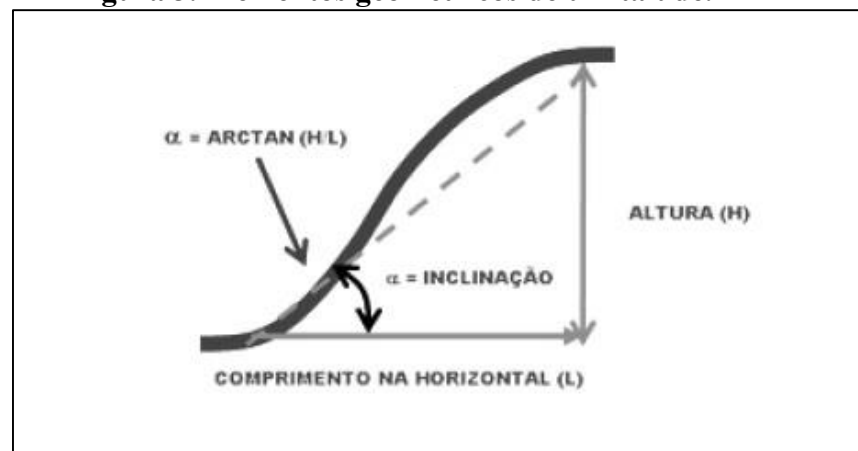
Figura 3. Elementos geométricos de um talude.
