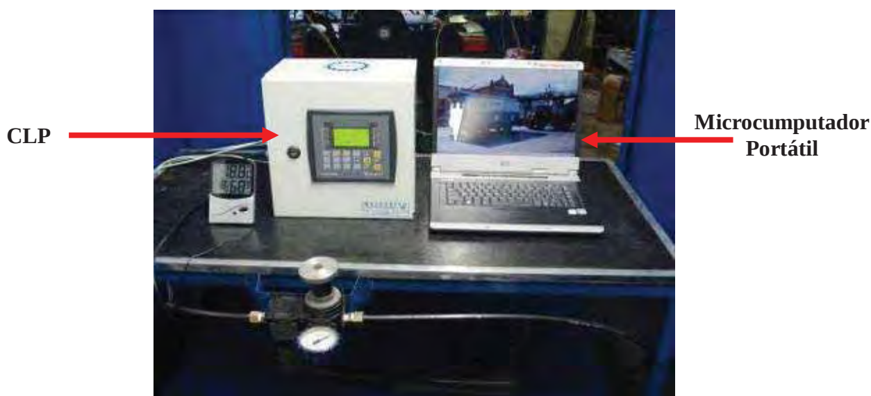
Figura 6 – Bancada de Instrumentação com o CLP e um microcomputador portátil
