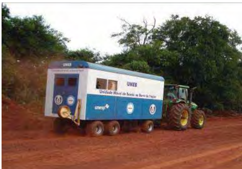
Figura 7 - Conjunto trator e Unidade Móvel para Ensaio na Barra de Tração – UMEB.
