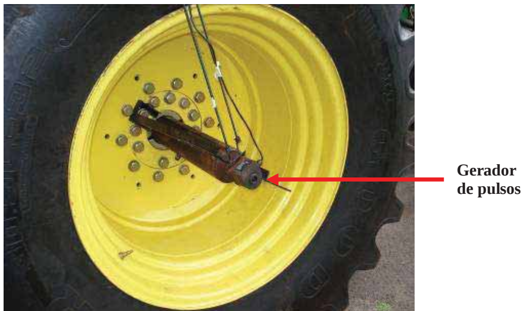
Figura 9 - Geradores de pulsos instalados no trator para determinar a patinagem nos rodados
