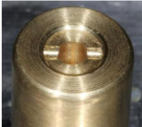
Figura 5. Visão do parafuso posicionado na EMIC.
