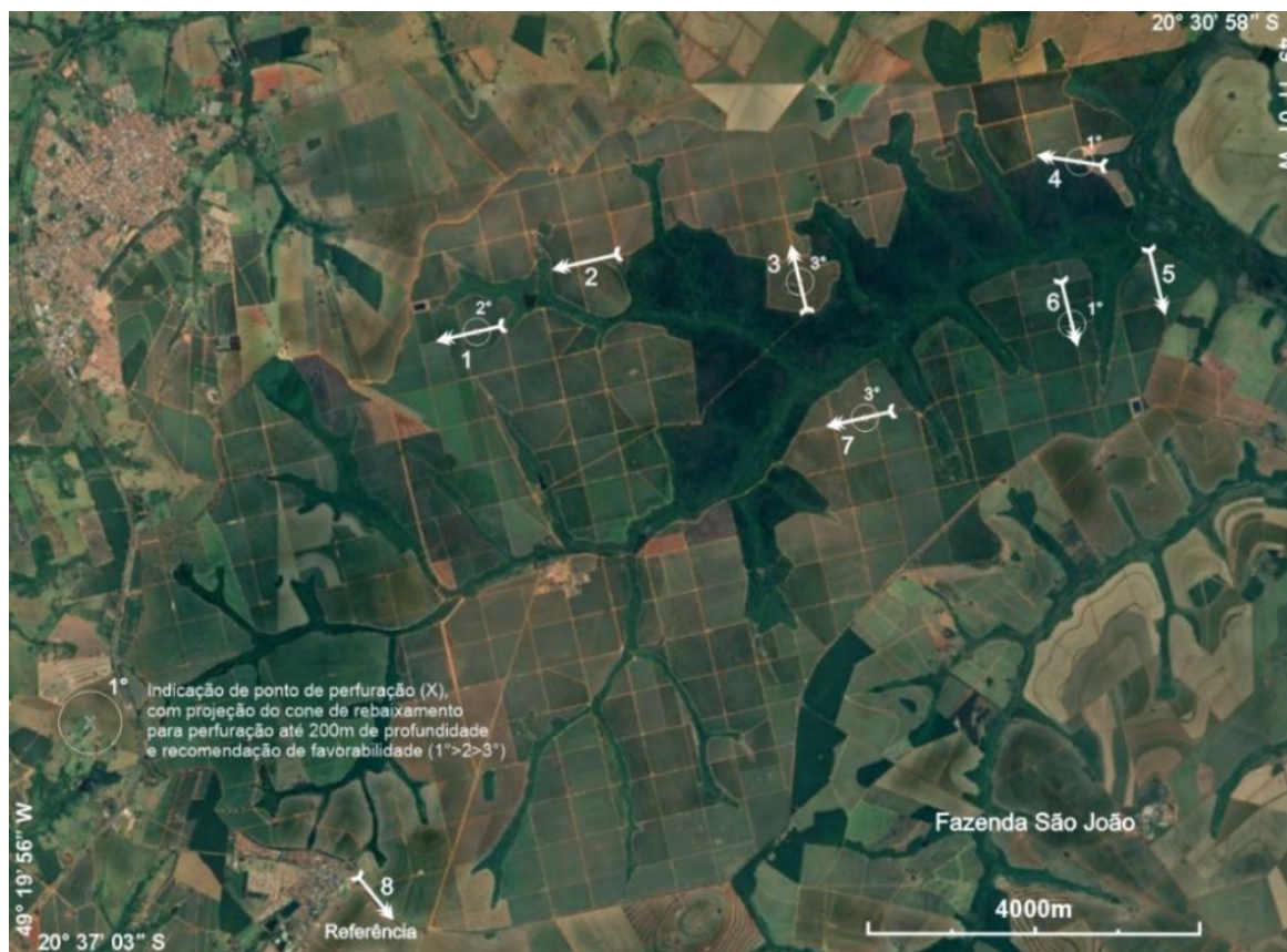
Figura 22: Pontos recomendados para perfuração de poços até 200m de profundidade, com projeção de cones de rebaixamento em superfície e recomendação de prioridade baseado no potencial aquífero local.
