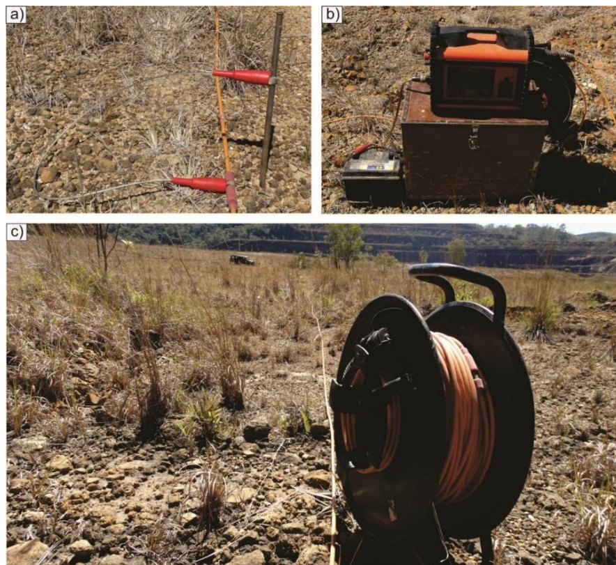
Figura 10: Aquisição de dados geofísicos por meio de técnica de tomografia elétrica. a) Detalhe do sistema de aterramento elétrico para aquisição de dados. b) Resistivímetro tomográfico ABEM Terrameter LS em operação; c) Linha de tomografia elétrica durante aquisição de dados.
