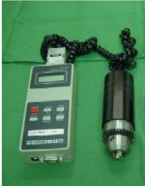
**Figura 16 – Torquímetro modelo BGI da marca Mark 10 Corporation.
