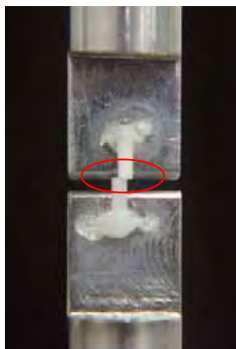
FIGURA 6 – Espécime fraturado após o teste de microtração.
