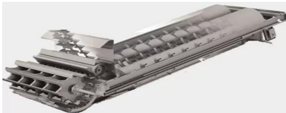
Figura 3- Sistema de trilha das colhedoras híbridas.
