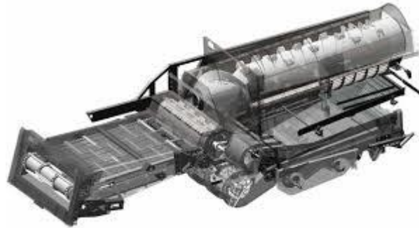
Figura 2 - Sistema de trilha das colhedoras de fluxo axial.
