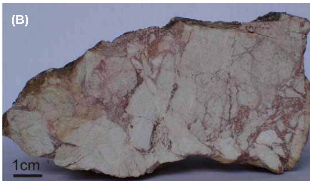
Figura 15. (A) Quartzito cataclasado observado na descida da Serra do Itambé (ponto SP-28). (B) Quartzito brechado, com matriz de óxido de Fe e aspecto poroso, friável (ponto SP-29).
