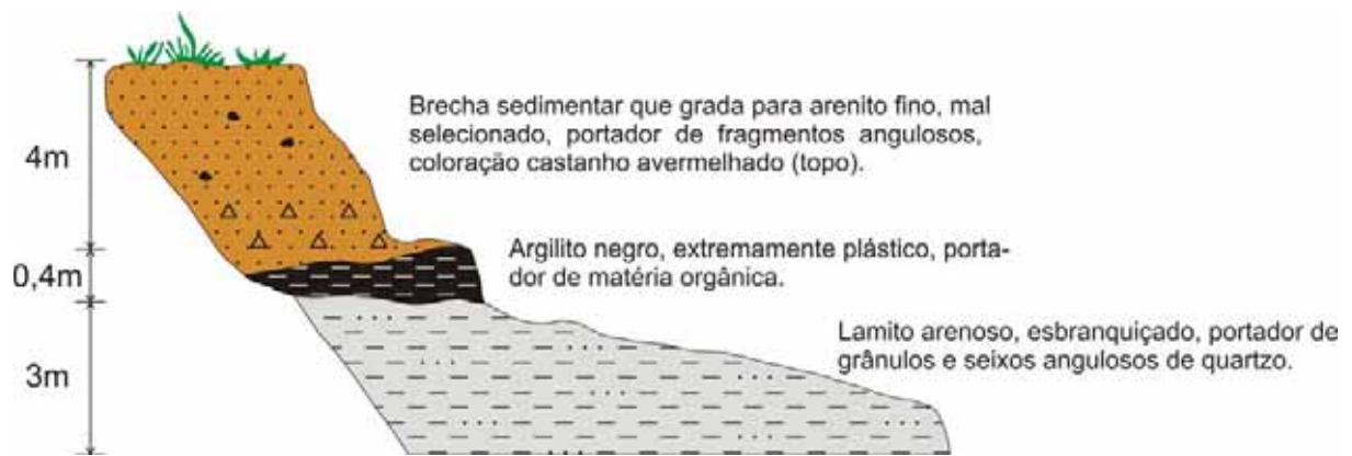
Figura 4. Perfil litológico preliminar de depósito sedimentar cenozóico, observado em cava abandonada de olaria (ponto SP-46), nas proximidades da cidade de Cássia/MG.
