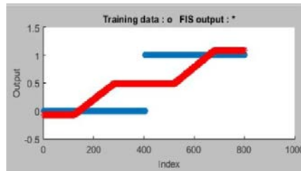
Figura 16 – Curva de resposta para três funções de pertinência
