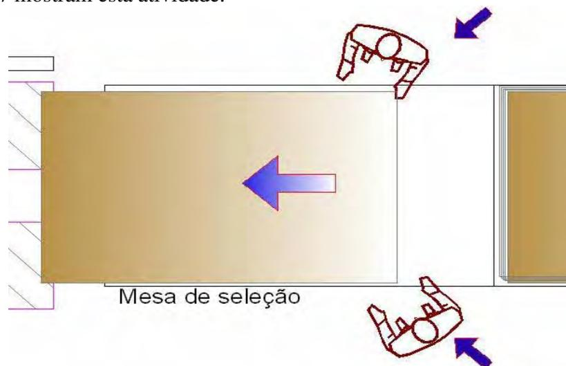
Figura 16 – Puxamento e início do empurramento do pacote de chapas
