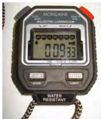
Figura 25 – Cronômetro utilizado para a análise das sub-atividades
