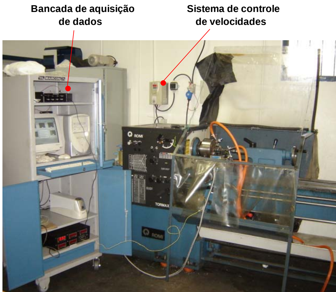
Figura 3.8 – Visão geral do sistema de aquisição de dados de força e temperatura e sistema de controle de velocidade.
