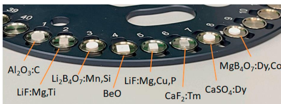
Figura 5 - Exemplos de alguns materiais utilizados como dosímetros em TL e OSL.
