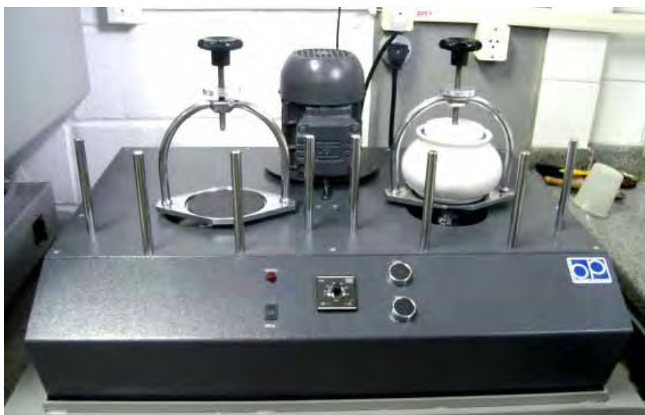
Figura 16: Moinho de bolas usado para homogeneização da barbotina
