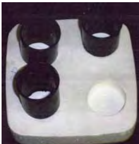
Figura 18: Fotografia do molde com base de gesso, utilizado na confecção das peças cerâmicas
