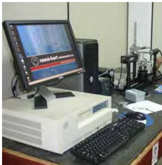
Figura 23: Goniômetro marca Ramé–Hart usado neste trabalho
