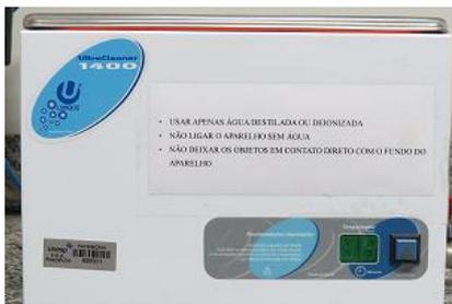
*Após utilização de cada lixa, os blocos foram submetidos ao ultrassom, em água deionizada, durante 21 minutos*
