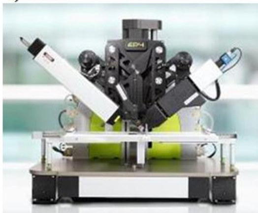
Figura 9: a) elipsômetro EP4SE acoplado a uma cuba de Langmuir modelo mini trough para as medidas de BAM. b) imagem digital do equipamento utilizado para as medidas de PM-IRRAS.
