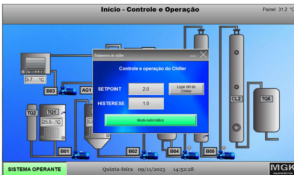
Figura 4 – Ajuste da temperatura do Chiller
