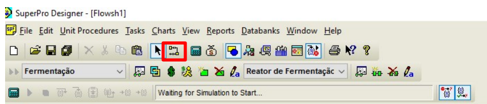
Figura 21 - Adicionando correntes de processo no reator de fermentação.
