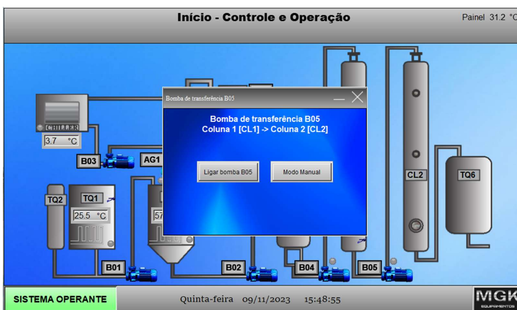
Figura 8 – Ajuste do modo de operação da bomba B05 de transferência do biodiesel da coluna CL1 para CL2
