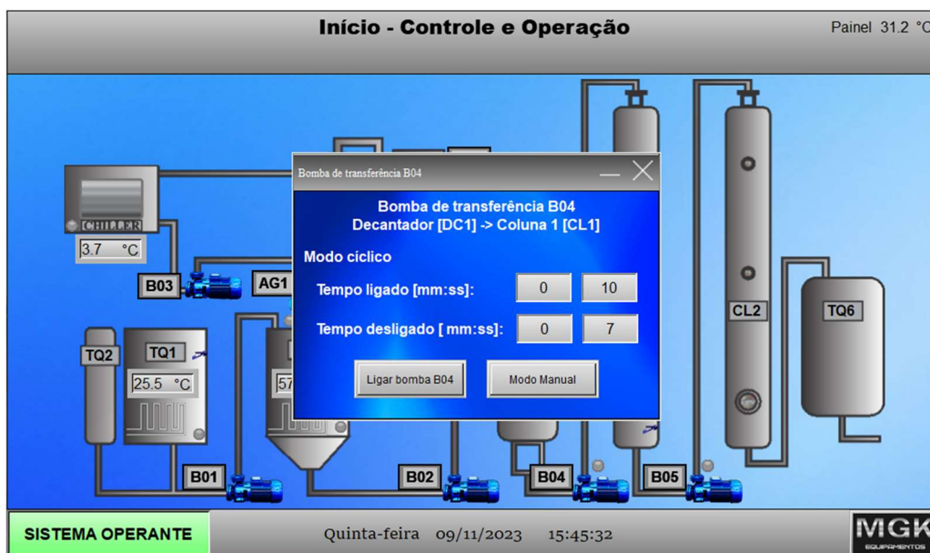
Figura 7 – Ajuste do modo de operação da bomba B04 de transferência do biodiesel do DC1 para coluna CL1
