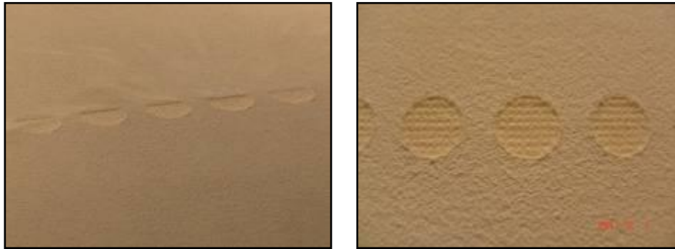
Figura 4 - Processo de confecção dos scaffolds de PHB por SLS.
