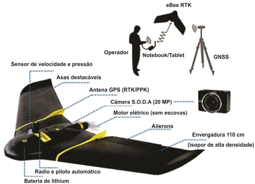
Figura 19 - Componentes do VANT eBeePlus e processo de aquisição.
