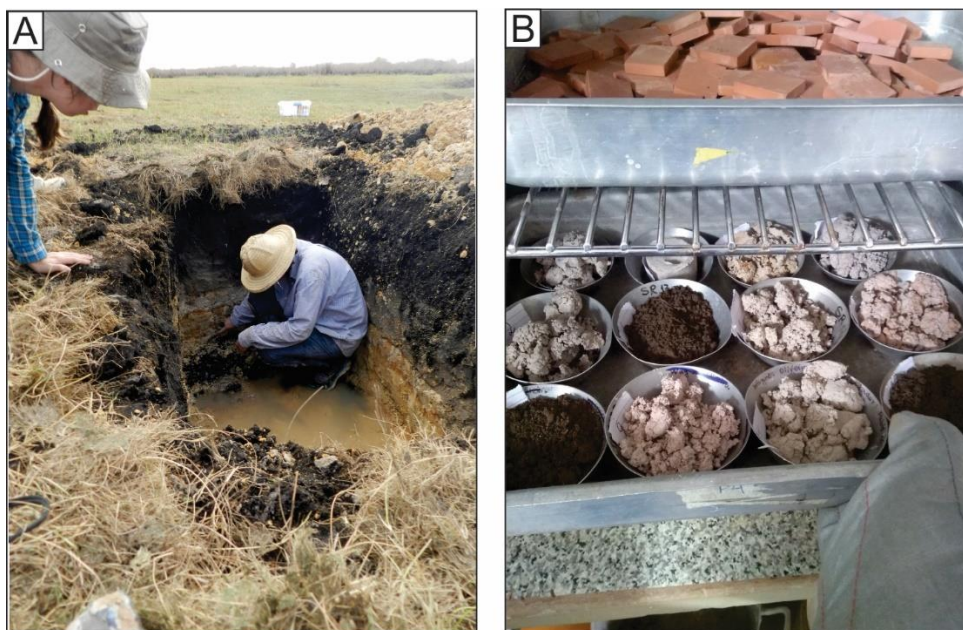
Figura 30 - A) Coleta das amostras; B) Estufa para secagem a 105 °C
