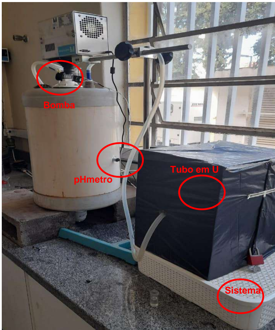
Figura 22 – Reator e sistema de controle instalado
