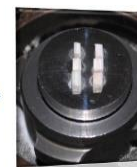
Embutimento dos blocos de esmalte com resina acrílica
