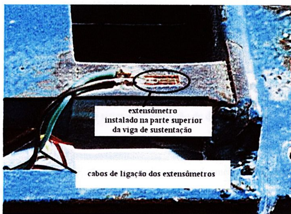
FIGURA 3.7 – Detalhe do extensômetro
