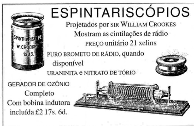
FIGURA 3.12 Os Espintariscópios eram vendidos em lojas especializadas da década de 1940 e ainda hoje o são. Esse pequeno instrumento contém uma tela fluorescente e uma lente ocular. No seu interior, uma quantidade extremamente pequena de brometo de rádio. (SACKS, 2002, p.255).
