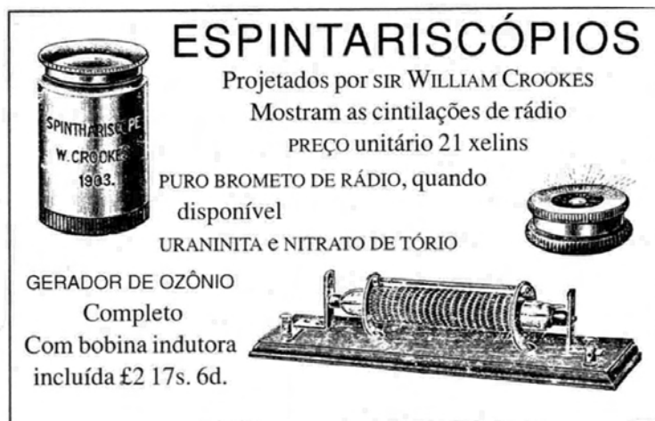
FIGURA 1 Os Espintariscópios eram vendidos em lojas especializadas da década de 1940 e ainda hoje o são. Esse pequeno instrumento contém uma tela fluorescente e uma lente ocular. No seu interior, uma quantidade extremamente pequena de brometo de rádio. (SACKS, 2002, p.255).
