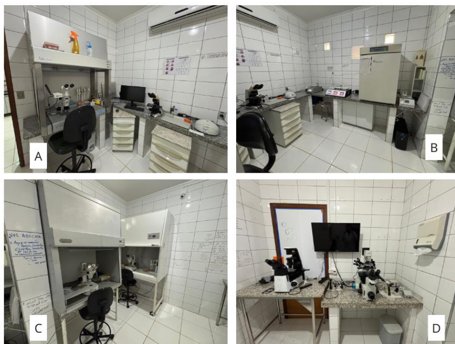
Figura 3. Sala de treinamento equipada com três fluxos laminares (A e C), incubadoras (B) e dois microscópios invertidos (D). Fonte: Arquivo pessoal.
