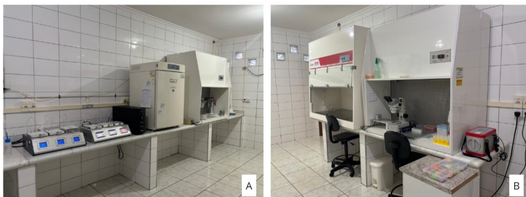
Figura 4. Sala de produção comercial. A: Incubadoras de bancada EVE e incubadora de CO 2 e fluxo laminar com lupa, mesa aquecedora, ponteiras e pipetadores. B: Dois fluxos laminares, um deles contendo lupa, mesa aquecedora, ponteiras, pipetadores e suporte para tubos. Fonte: Arquivo pessoal.
