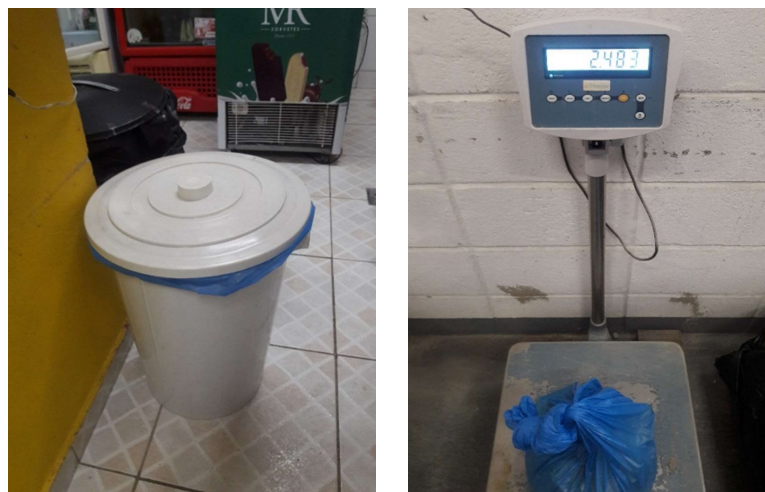
Figura 8 - Coleta e armazenamento em balde com tampa, dos resíduos alimentares produzidos na cantina da FEG/UNESP e pesagem em balança digital.
