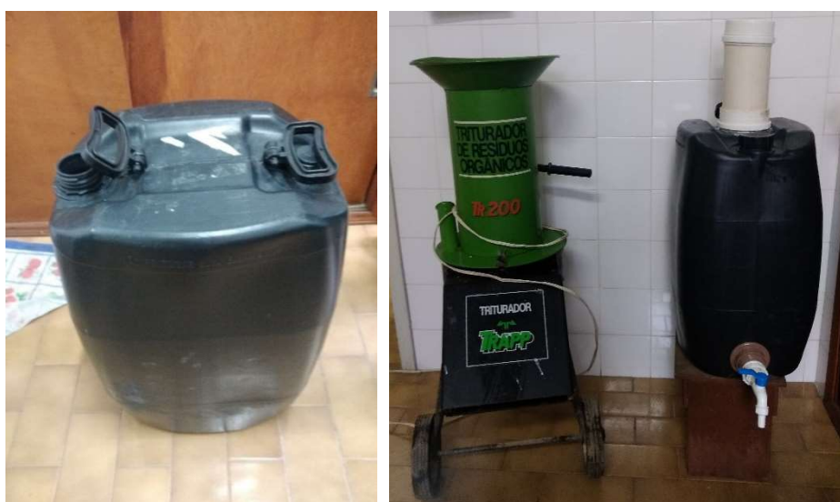
Figura 17 - Bombona utilizada como câmara de biodigestão (à esquerda) e o novo biodigestor finalizado (à direita).
