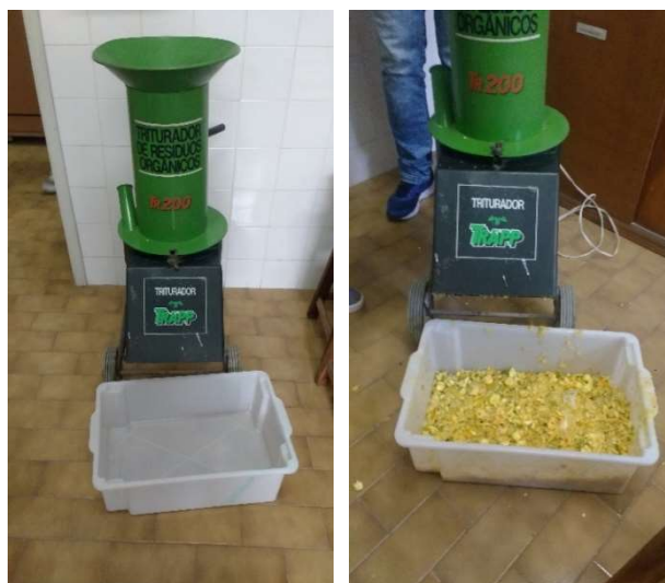
Figura 11 - Triturador de resíduos orgânicos TR 200, fabricado pela Trapp utilizado no estudo (à esquerda) e resíduos alimentares triturados (à direita).
