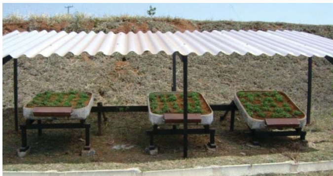
Figura 10 - Vista Frontal dos módulos-pilotos de telhado verde
