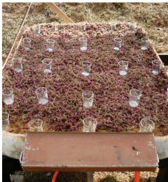
Figura 17 - Teste do Coeficiente de Uniformidade de Christiansen
