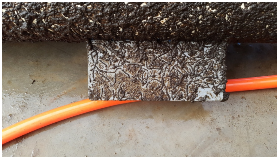
Figura 56 - Aparência dos microrganismos aderidos a toda parede de PVC do MABR
