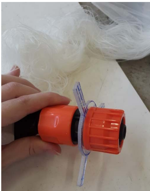
Figura 11 - Peça suporte de acrílico instalada na conexão de uma das extremidades da membrana
