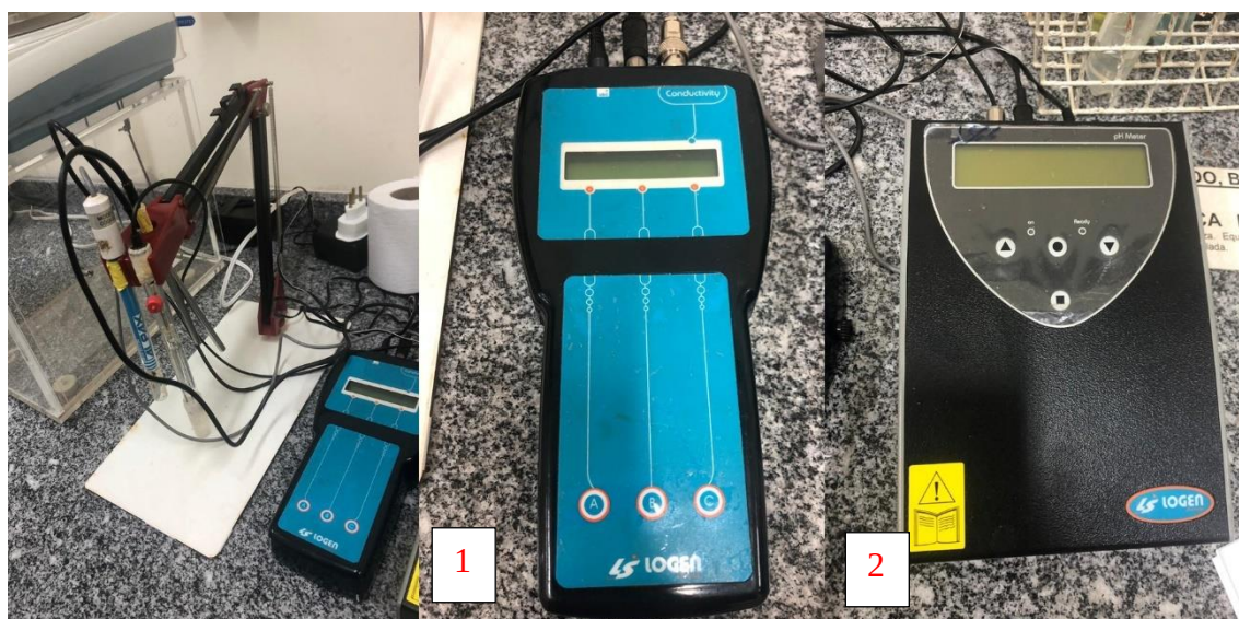
Figura 13. Equipamentos para verificar a condutividade (1) e o pH (2).
