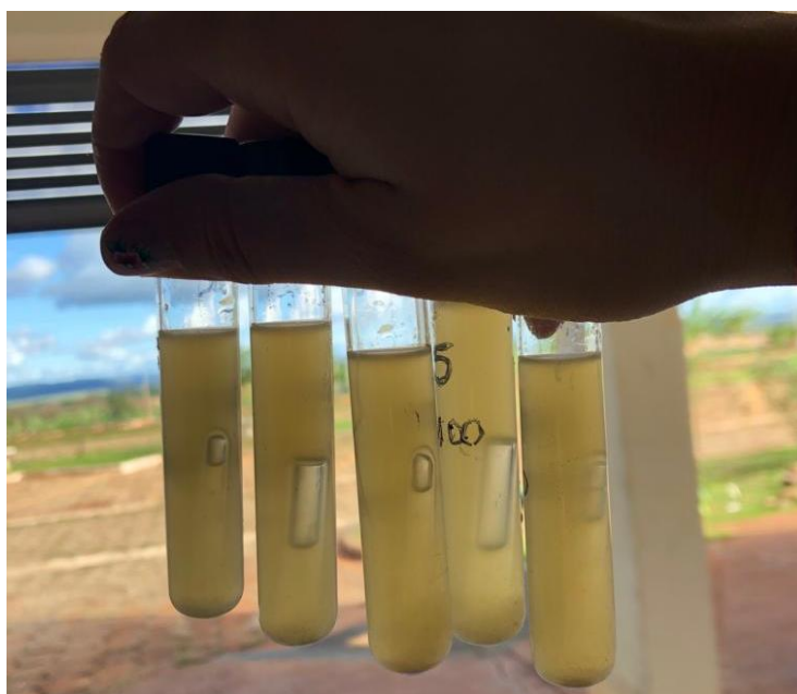
Figura 23. Resultado da análise de coliformes totais, com a formação de bolha de ar.
