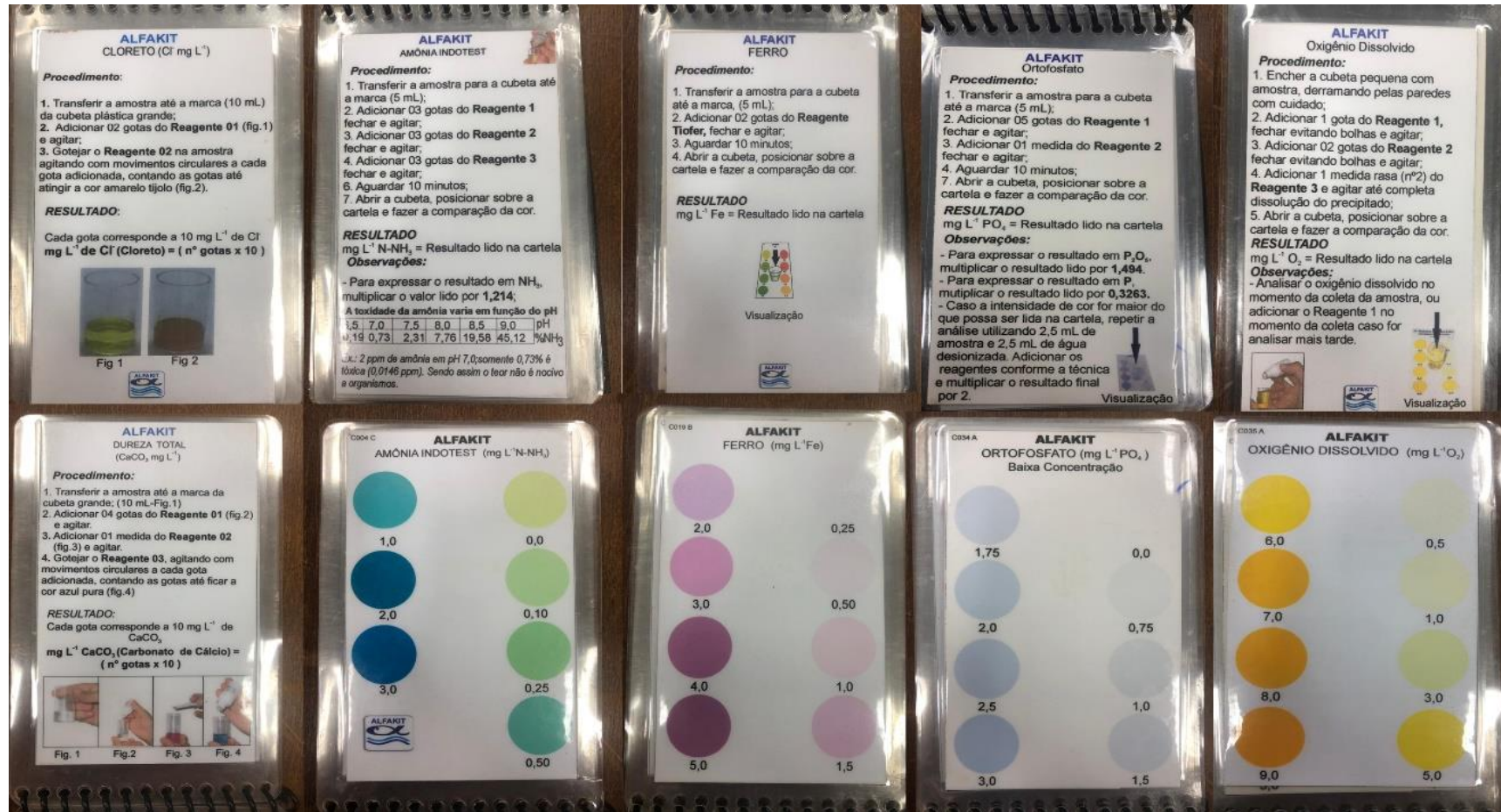
Figura 14. Método de análise de água conforme o ecokit.
