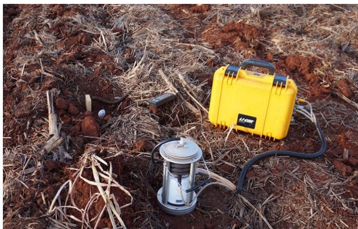
Figura 2.2. Sistema LI-COR (LI-8100A), sensor de temperatura do solo e aparelho TDR para medir umidade do solo.
