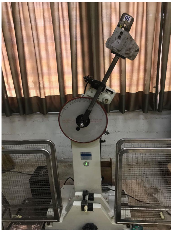
Figura 3: Máquina JB-W300A com faca de corte basal acoplada no martelo pendular e colmo de cana-de-açúcar como corpo de prova.
