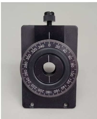
Figura 11: Polarizador do tipo Glan Thompson Polarizer (modelo PTH-SMP) empregado nas medidas de anisotropia óptica por meio de absorção UV-Vis.
