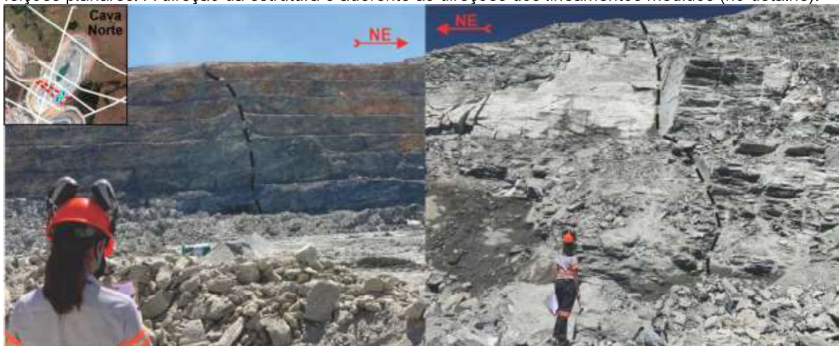
Figura 6.10 – Estrutura medida no ponto 2 da Cava Norte (N50W/80NE). À esquerda é vista a estrutura na bancada NW da cava, e à direita (bancada SE) a continuidade do plano com rochas mais fraturadas e feições planares. A direção da estrutura é aderente às direções dos lineamentos medidos (no detalhe).
