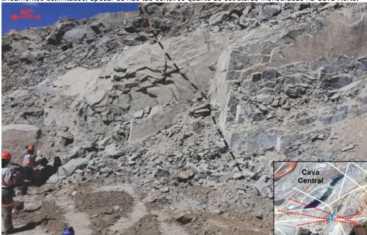
Figura 6.12 – Estrutura medida na Cava Central (N70W/80NE) no ponto 6, com pequenas variações devido ao alto ângulo de mergulho e interferência de famílias de fraturas. Ocorre certa coerência com os lineamentos delimitados, apesar de não tão certos quanto as estruturas mensuradas na Cava Norte.
