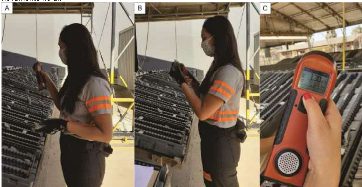
Figura 5.1 – Medidas de susceptibilidade magnética obtidas pela técnica em mineração com o kappameter . Em (A) a primeira mensuração é feita no ar livre a fim de calibrar o aparelho; em (B) a medida da amostra realizada, e em (C) o valor mensurado aparece no visor do aparelho após a terceira medição feita novamente no ar.
