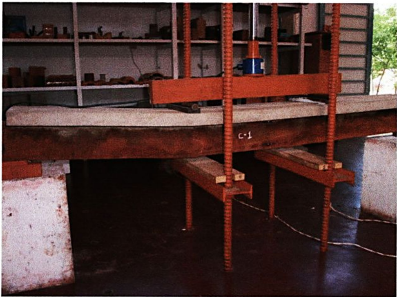
Figura 03 – Ruptura da viga mista
