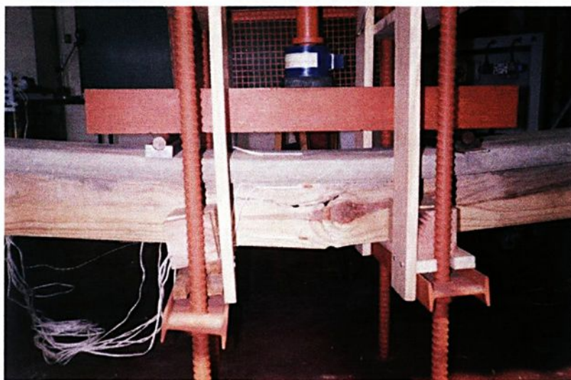
Figura 08 – Ruptura da viga e detalhe do nó
