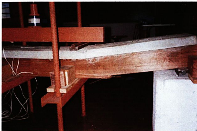
Figura 11 – Ruptura total da viga mista
