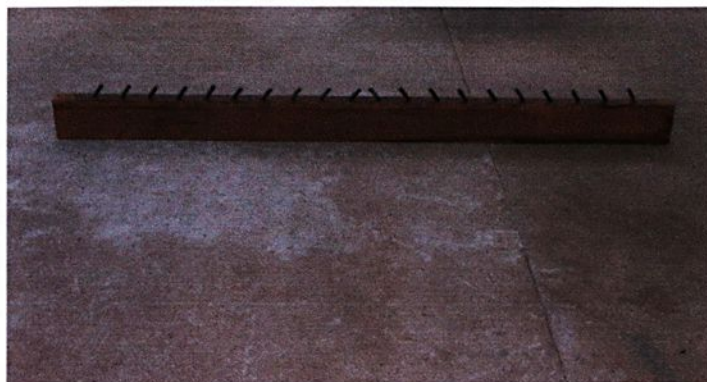
Figura 01 – Viga com pinos de ferro
