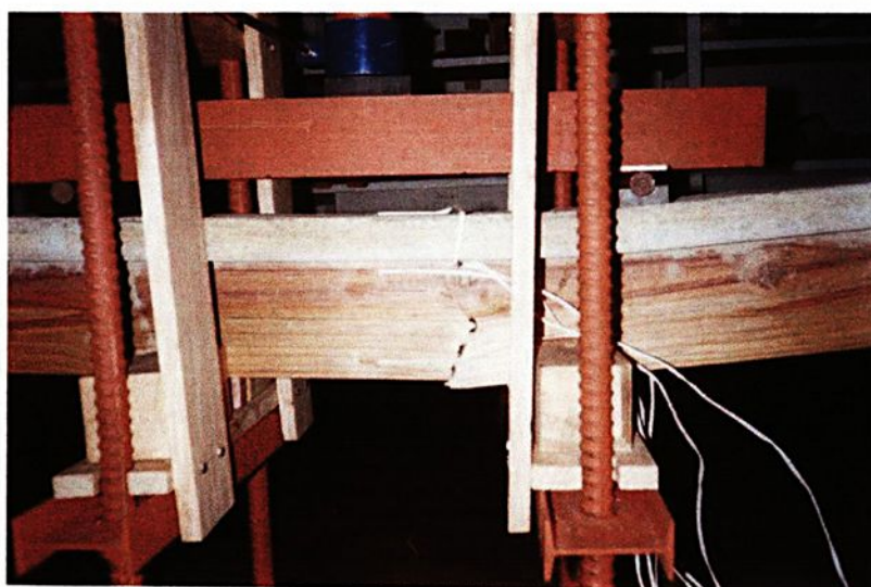
Figura 09 – Vista da ruptura da outra face da viga mista 2
