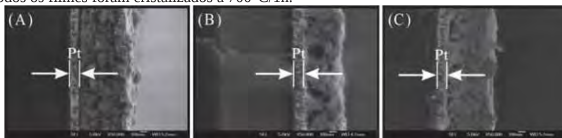
Figura 30 – Microscopia eletrônica de varredura por emissão de campo para os filmes de PZT50 com 10 mol% de excesso de \text{PbO} depositados sobre substratos de \text{Pt}/\text{Ti}/\text{SiO}_2/\text{Si}(100) com tratamentos térmicos realizados a 450^\circ\text{C}/0,5\text{h} (A), 400^\circ\text{C}/0,5\text{h} (B) e 300^\circ\text{C}/0,5\text{h} (C). Todos os filmes foram cristalizados a 700^\circ\text{C}/1\text{h} .
