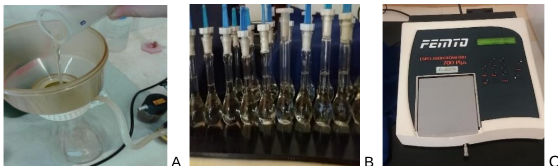
Figura 12 - A: Filtração para a extração do pigmento, B: Amostras prontas para leitura, C: Espectrofotômetro Femto 700 Plus.
