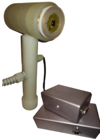
Figura 3 – Conjunto real BAC-AMR com o pré-amplificador (módulo maior) e conversor True-RMS-to-DC (módulo menor).
