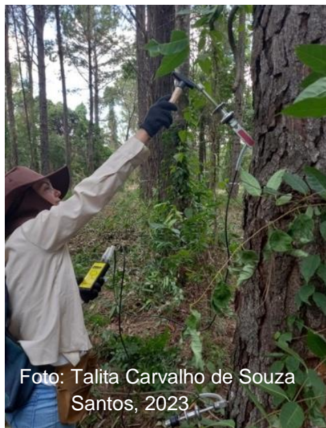
Figura 3 – Equipamento de Ultrassom portátil (Tree sonic) instalado na árvore
