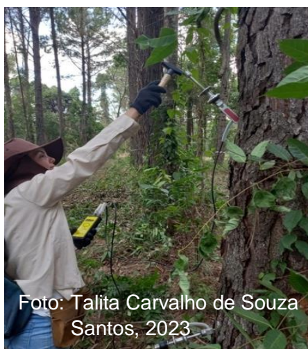
Figura 3 – Equipamento de Ultrassom portátil (Tree sonic) instalado na árvore
