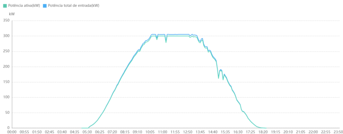
Figura 25 - Curva de potência dos inversores de 330 kW com módulos de 550 W.
