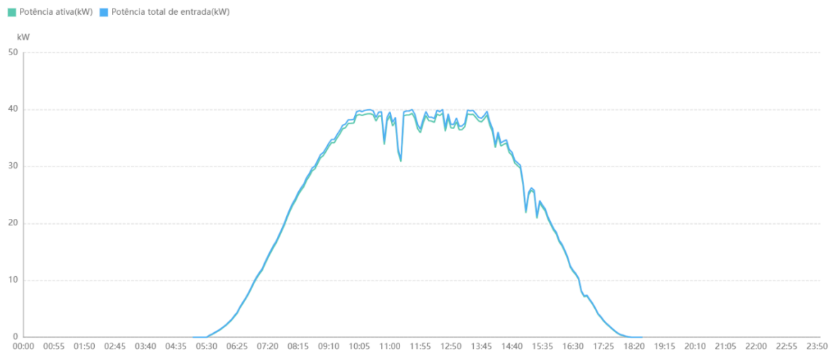
Figura 27 - Curva de potência de um inversor 40 kW e módulos de 550 W.
