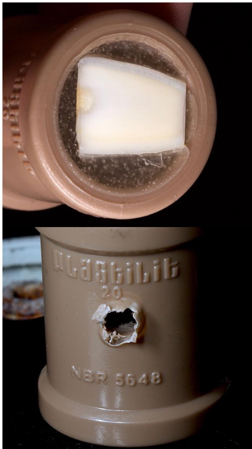
Figura 3 – Dente incluído no cano e orifício criado para adaptação da amostra no dispositivo de tração
