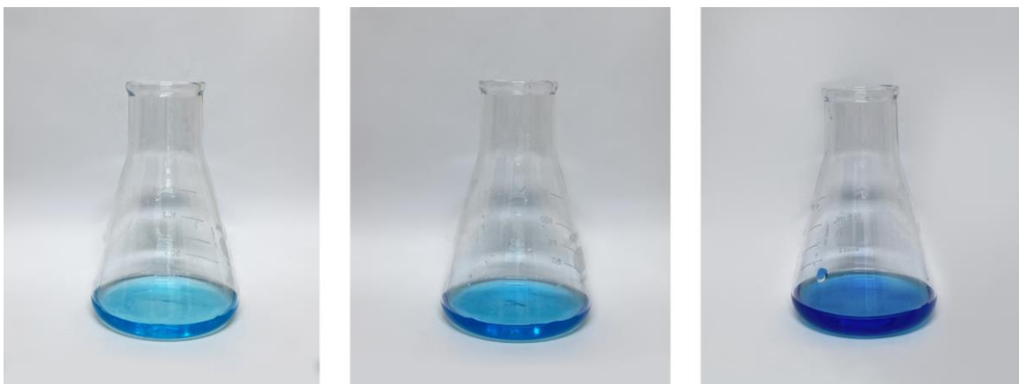
Figura 19 – Corante Azul de Metileno solubilizado em água deionizada nas concentrações de 5, 10 e 20ppm
