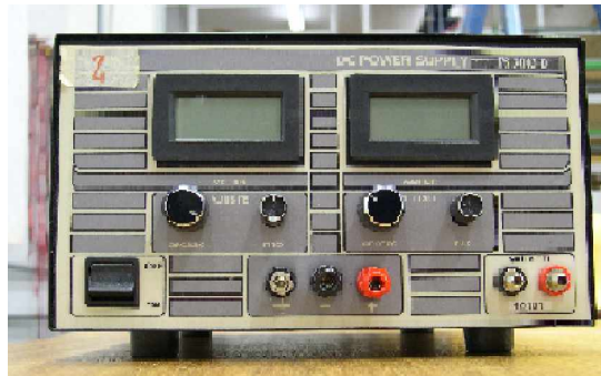
Figura 4.9: Gerador de corrente modelo PS 3003 D
