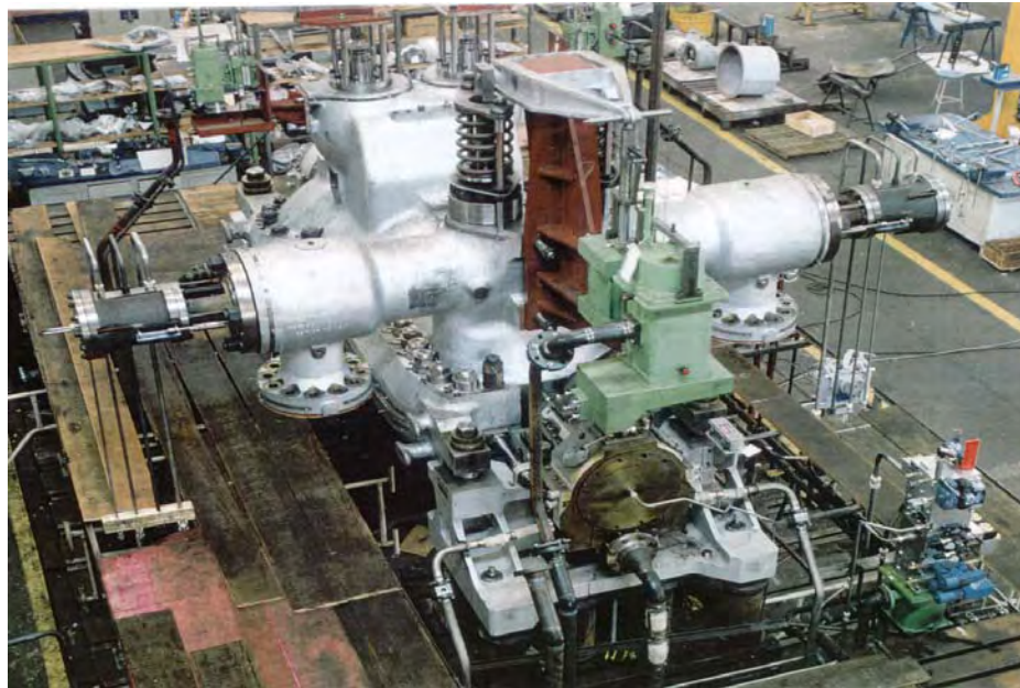
Figura 27 - Turbina a vapor multi-estágio montada
