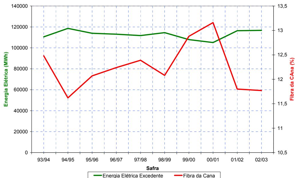
Figura 77 – Gráfico comparativo do excedente de energia elétrica e o teor de fibra
