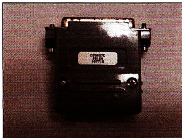
Figura 4.26 : Adaptador serial modelo DS9097E.
