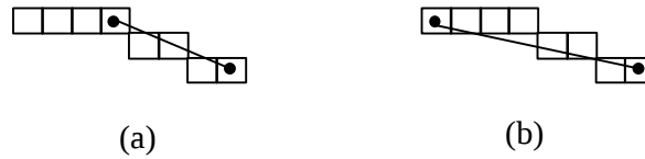
Figura A1.5- Localização dos pixels extremos (a) antes e (b) depois da correção.
