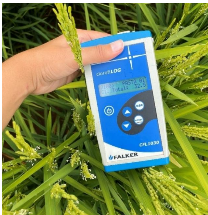
Figura 14 – Leitura do teor de clorofila em planta de arroz de terras altas com clorofilômetro portátil, Dracena-SP, safra 2024/25
