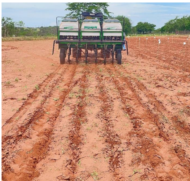
Figura 5 – Abertura dos sulcos de semeadura e aplicação do adubo de plantio com o uso de semeadora-adubadora mecanizada, Dracena-SP, safra 2024/25
