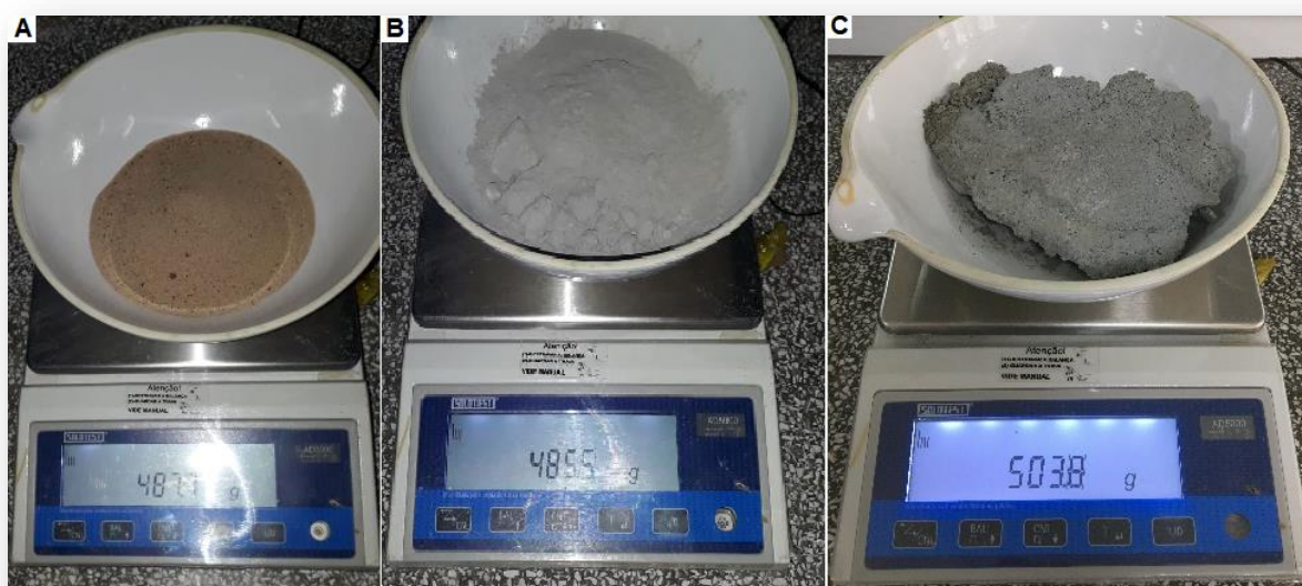
Figura 14 – (A) Massa da areia após o ensaio e a secagem. (B) Massa do RPPO após o ensaio e a secagem. (C) Massa do cimento CPV-ARI após o ensaio e a secagem.
