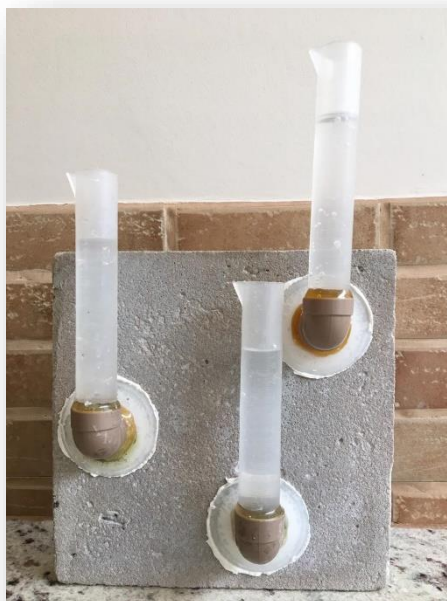
Figura 27 – Cachimbo com água e fixado na chapa cimentícia.
