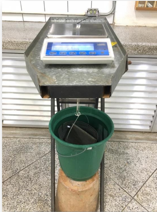
Figura 28 – Pesagem da chapa cimentícia imersa em água.
