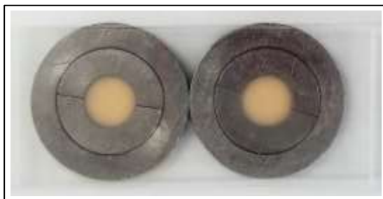
Figura 4 - Confeção de corpos de prova com cimento resinoso
