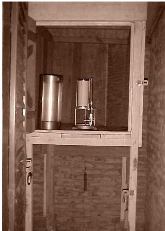
Figura 6 Linígrafo modelo LNG-9 utilizado no experimento.
