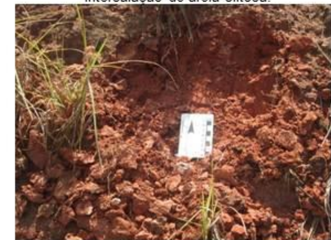
Solo argiloso; Intercalação de areia siltosa.
