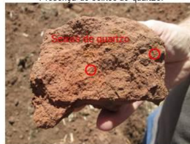
Evidências de camadas coluvionares: Presença de seixos de quartzo.
